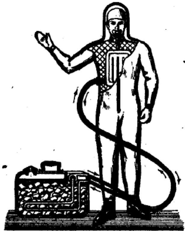
Рис. 9. Принцип вынесения: раньше горноспасатель носил на спине ранец с холодильным устройством; теперь оно помещено в отдельном контейнере.
